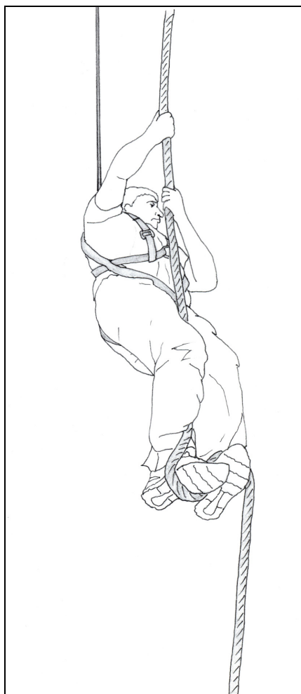
figura 2: Salita della fune con imbragatura di sicurezza collegata al dispositivo anticaduta
